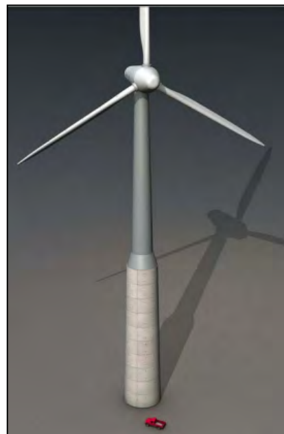
Figura 7: Prototipo de torre híbrida estudiado por BergerABAM (BergerABAM, 2011)
